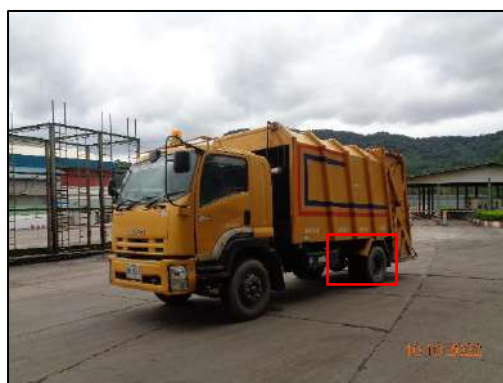
รูปที่ 2-31 รถขนส่งขยะที่มีการติดตั้งกล่องรับน้ำเสีย
