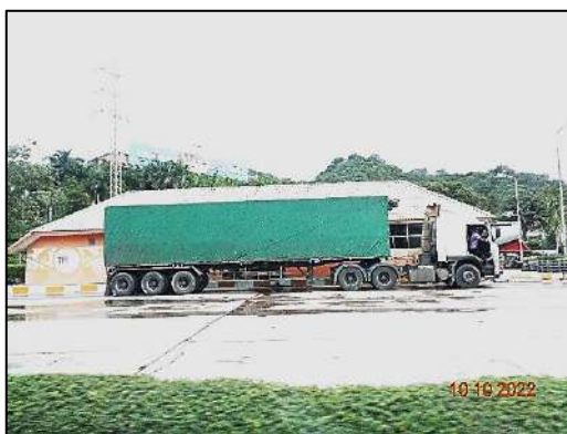
รูปที่ 2-3 การปิดคลุมส่วนกระเบรบรรทุกของรถ ที่ใช้ในการขนส่ง
